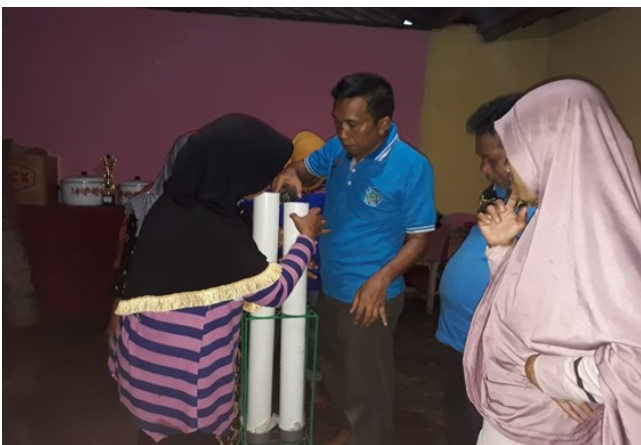
Gambar 5. Minyak Kelapa Dimasukkan Ke Dalam Pipa Penyuling untuk Mengeluarkan Kadar Air
