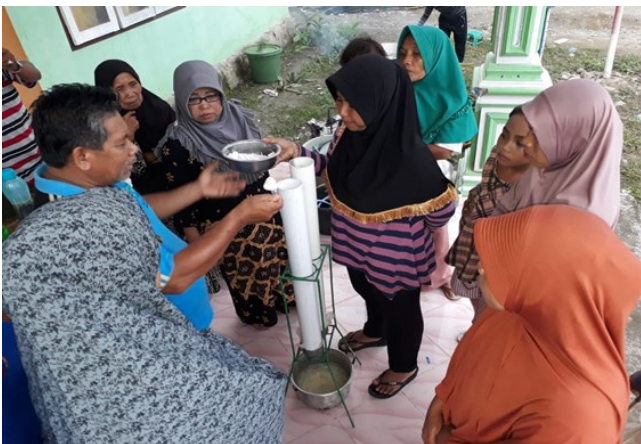
Gambar 4. Abu Gosok Dimasukkan Ke Dalam Pipa Untuk Menarik Air yang Ada dalam Minyak
