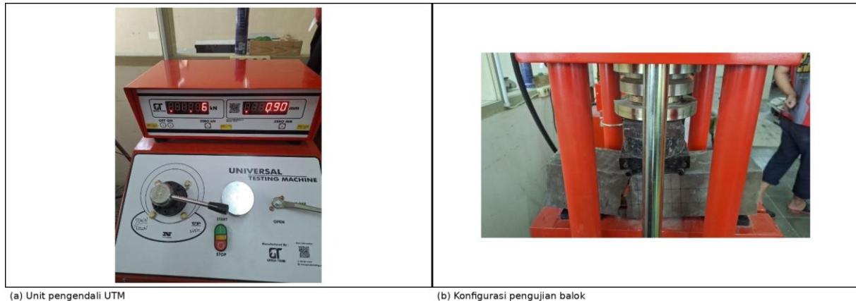
Gambar 1 Konfigurasi pengujian kuat tarik lentur
