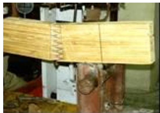
Gambar 5 Keruntuhan yang terjadi pada balok laminasi BLP-BJ
