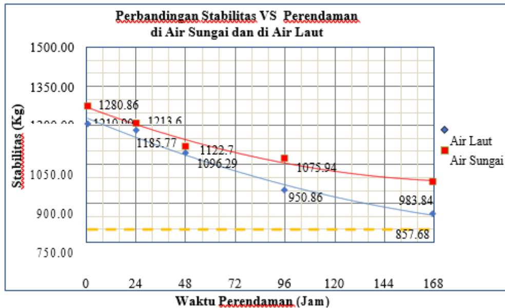
Gambar 7 Grafik hubungan stabilitas vs waktu perendaman di air sungai dan air laut
