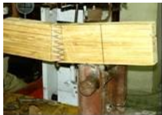
Gambar 5 Keruntuhan yang terjadi pada balok laminasi BLP-BJ
