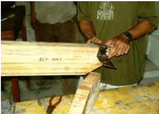
Gambar 6 Keruntuhan yang terjadi pada balok laminasi (BLP-BM)
