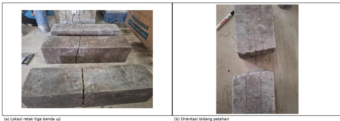
Gambar 3 Lokasi dan orientasi bidang retak balok
