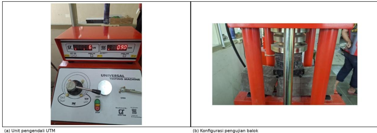
Gambar 1 Konfigurasi pengujian kuat tarik lentur
