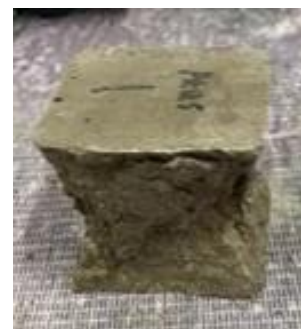
Gambar 2 Pola keruntuhan mortar geopolimer
