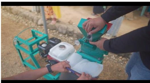
Ket. Proses Penghalusan menggunakan mesin pengiling
