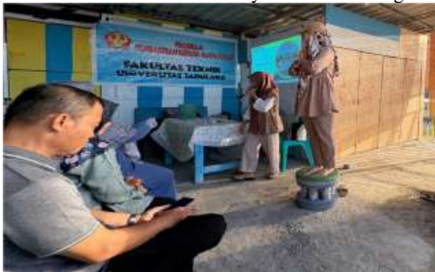
Gambar 4. Uji kekuatan produk kursi dari rangka Eco brick
