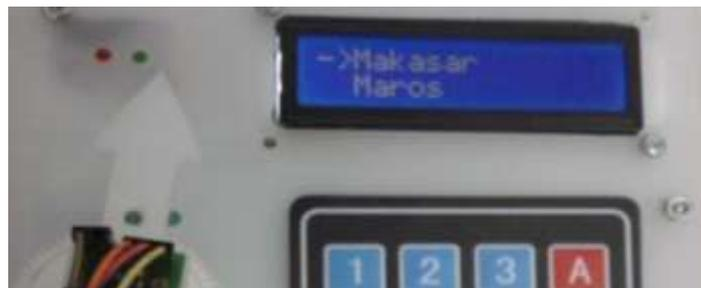
**Gambar 5.** Hasil percobaan tampilan LCD ketika memilih lokasi untuk menentukan suatu lokasi.
