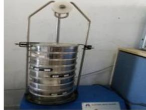
Gambar 3. Alat Uji Analisa Saringan
