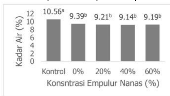
Gambar 2. Grafik Pengaruh Konsentrasi Pelarut Empulur Nanas Madu terhadap Kadar Air Kopi Robusta Terdekafeinasi Menggunakan Alat UAE
